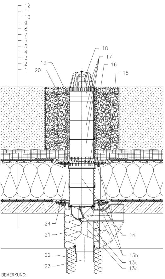
ZUM BEHEIZEN DES ABLAUFES KANN DAS BEGLEITHEIZUNGSSET HL82 MIT SELBSTREGULIERENDER WÄRMEQUELLE 18W/23OV VERWENDET WERDEN. (DAS HEIZBAND WIRD VOR DEM VERLEGEN DES ABLAUFES UM DEN ABLAUFKÖRPER GEWICKELT)
